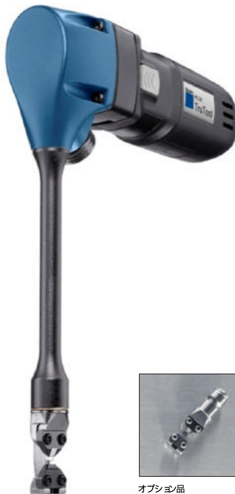
オプション品 ツールホルダー・ショートタイプ (交換はスピーディーに行なえます)
