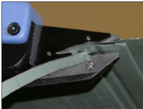
横葺成型材の切断
